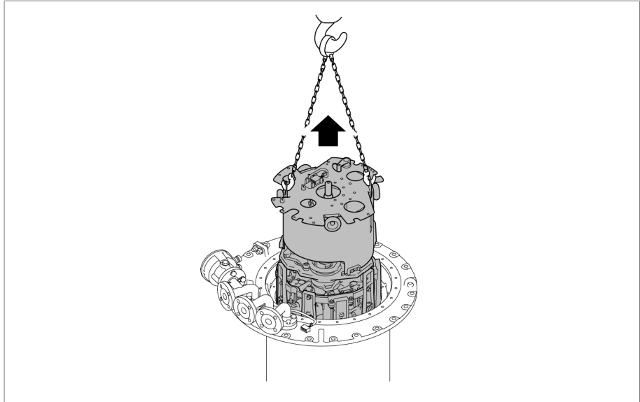
插图 57: 吊出切换开关芯子
