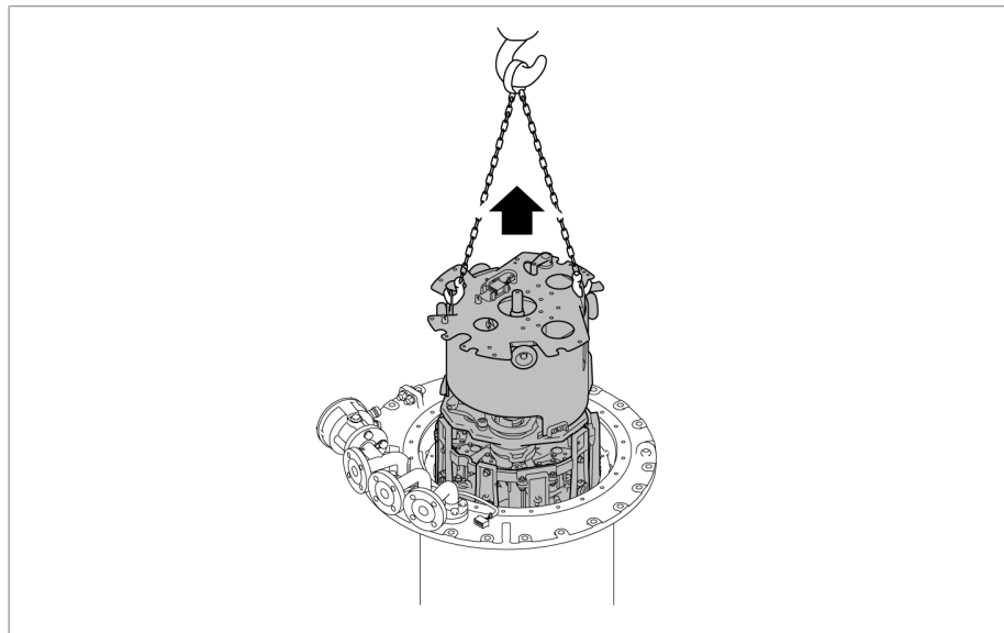
插图 108: 吊出切换开关芯子
